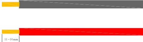
2. Führen Sie den schwarzen Draht in die blaue Klemme, den roten Draht in die rote Klemme ein und ziehen Sie die Schrauben fest an. Siehe unten:
